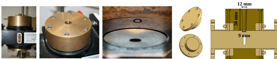
Figure C.18 – Photographies et représentation 3D de la cavité équipée des bouchons en laiton
