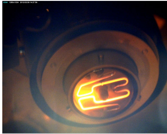
FIGURE 2.37 – Filament en tungstène alimenté en courant.
