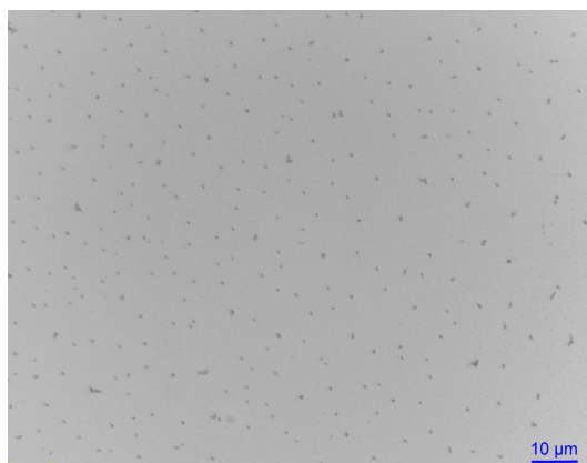
FIGURE 3.46 – Image optique d'un échantillon déposé à 1040 K de 2 mono-couches d'épaisseur.
