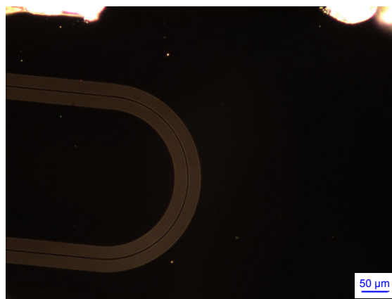
FIGURE 3.78 – Image optique d'un échantillon de 25 nm déposé à 970 K laissé à l'air plusieurs mois après nettoyage à l'eau déionisée. Les objets 3D de la figure 3.77 ont tous disparus.
