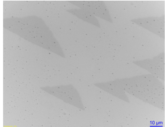
FIGURE 3.49 – Image optique d'un échantillon de type C de 30 mono-couches de rhénium.
