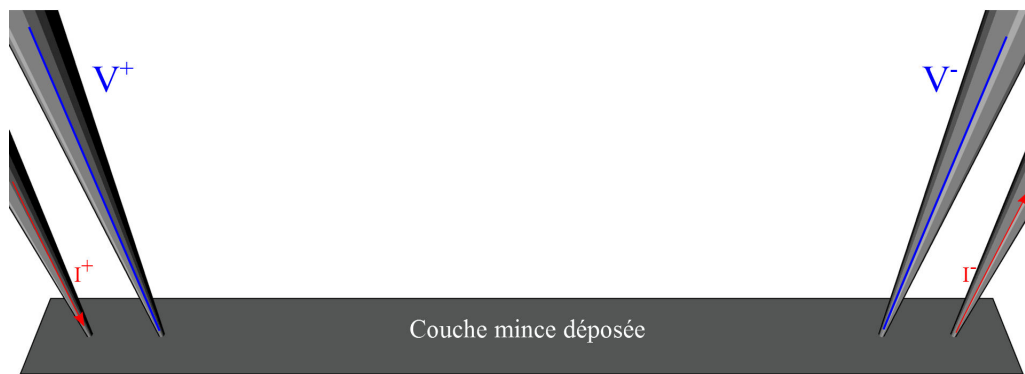
FIGURE 4.5 – Représentation schématique d'une mesure 4 points à géométrie simplifiée.
