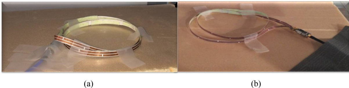
Fig. 4.23 : Antenne bracelet fixée sur un support en polystyrène : (a) prototype 1, (b) prototype 2.
