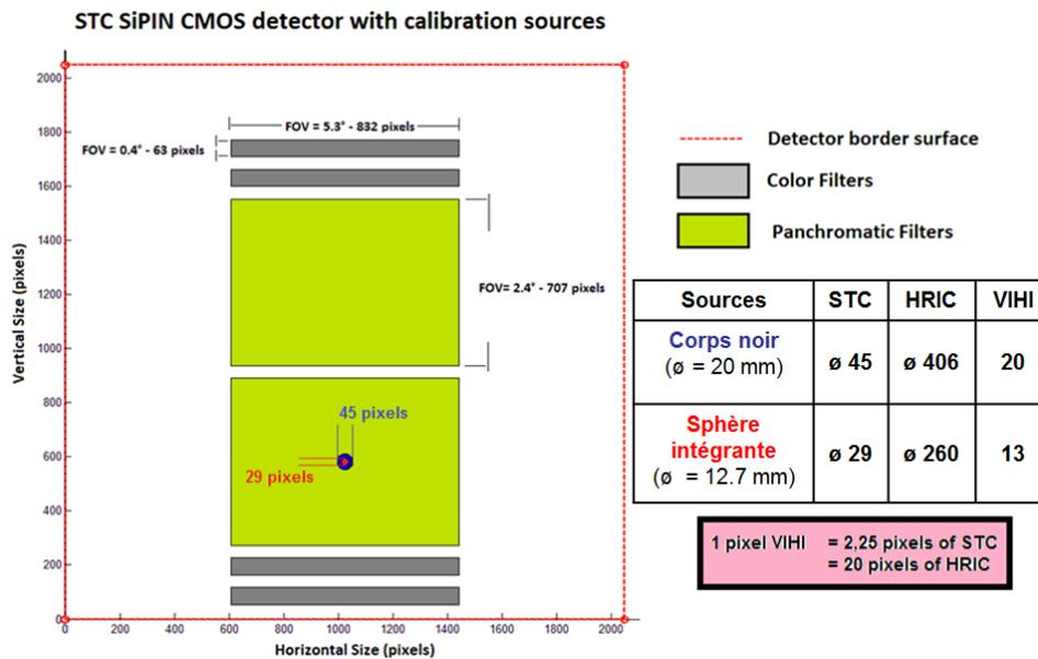
**Figure 4-3 Surface en pixels, sur chaque détecteur, éclairé par les sources radiométriques du BO. Les images des sources corps noir (cercle bleu) et sphère intégrante (cercle rouge) sont superposés sur le détecteur de STC. Chacune des sources éclaire un cercle de 45 et 29 pixels de diamètre respectivement, ce qui est suffisant pour réaliser l'étalonnage radiométrique de chaque filtre.**
