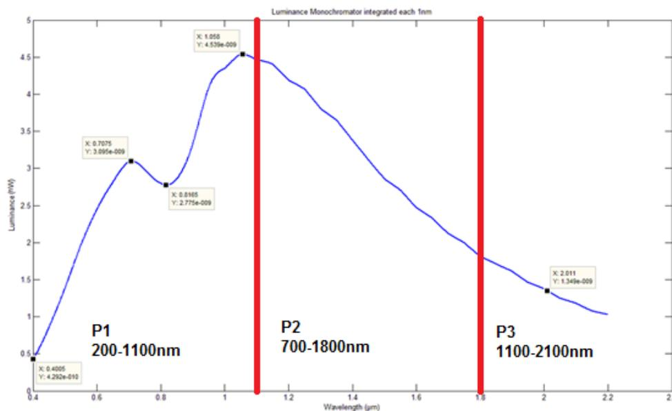
Figure 3-19. L'excitance en [W/m<sup>2</sup>] de la source monochromateur.
