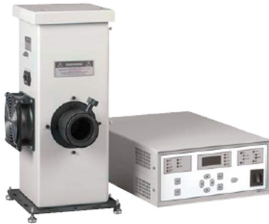
Figure 2-20. La source QTH du banc optique. Elle est composée par le boîtier de la lampe (à gauche) et le boîtier de la source de courant (à droite).
