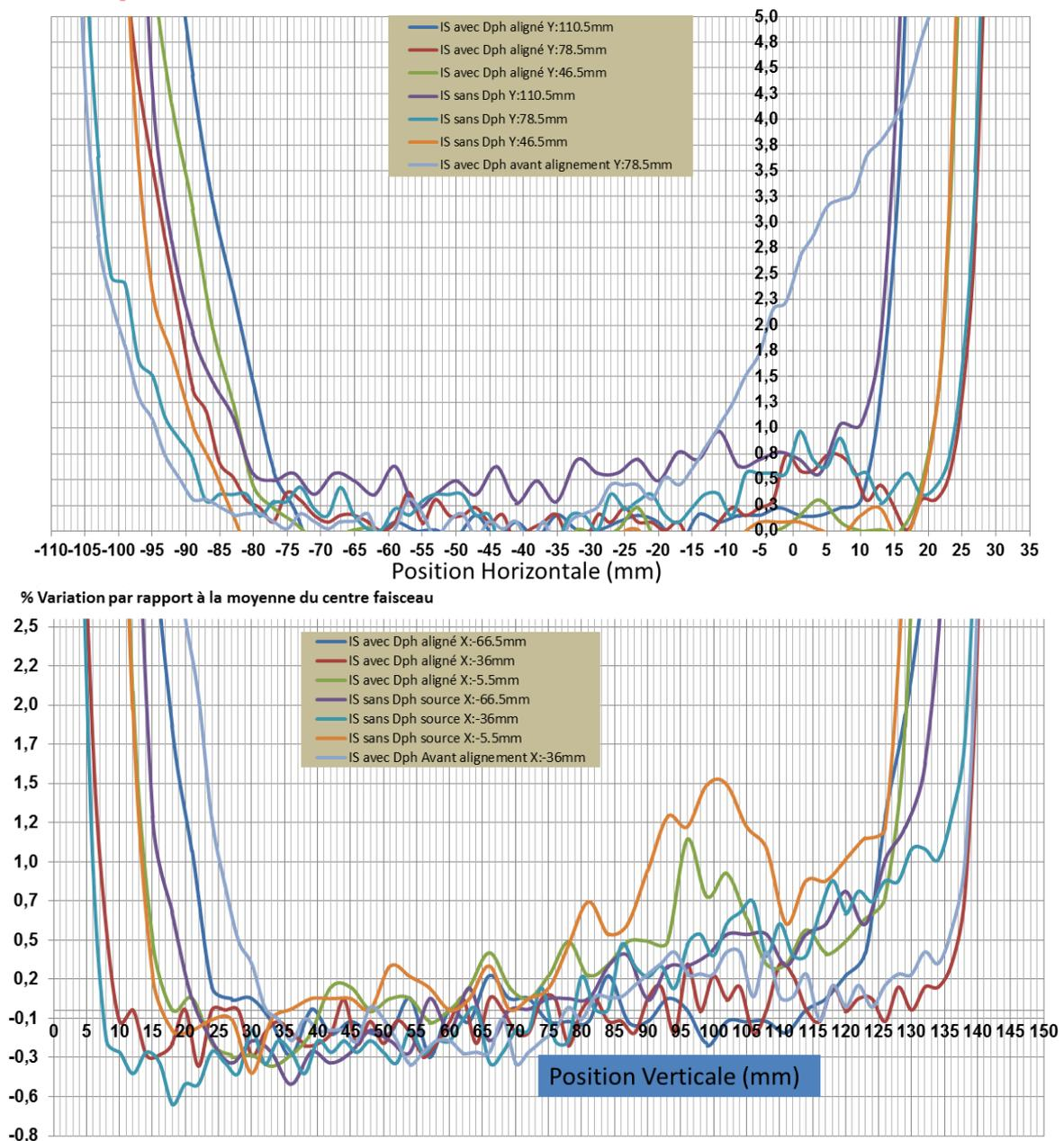
Figure 4-14 Rapport du flux avec la moyenne autour du centre du faisceau de la sphère intégrante obtenu à partir des mesures de la Figure 4-13.
