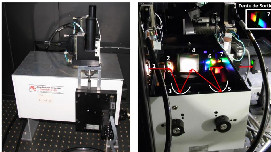
Figure 2-23. Source monochromateur du banc optique de SIMBIO-SYS.
