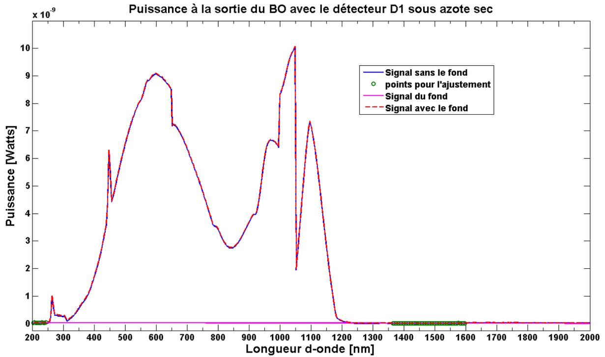
Figure 4-24 Signal détecté avec D1 en sortie du banc optique purgé avec l'azote sec avant et après avoir enlevé le niveau du fond.
