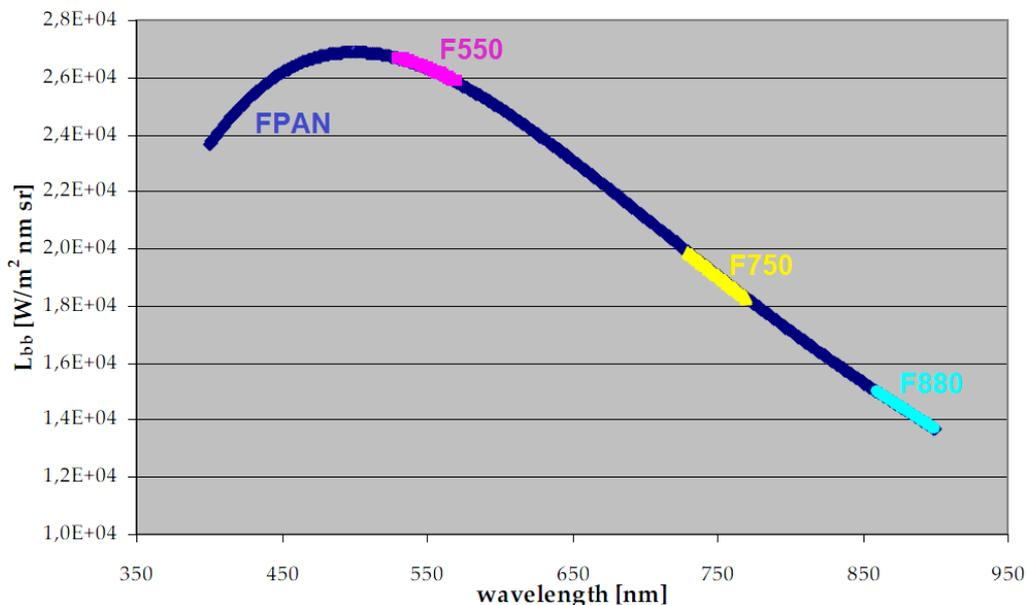
Figure 3-13. Luminance spectrale de Mercure vue par les différents filtres de HRIC.
