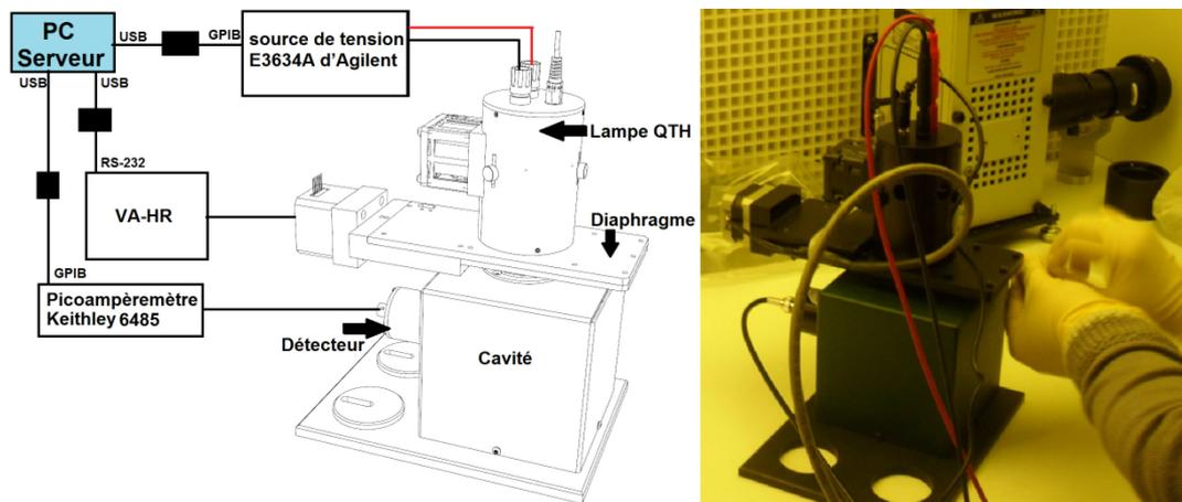
Figure 2-18. La source sphère intégrante LR-4Z-H de Labsphere/SphereOptics.
