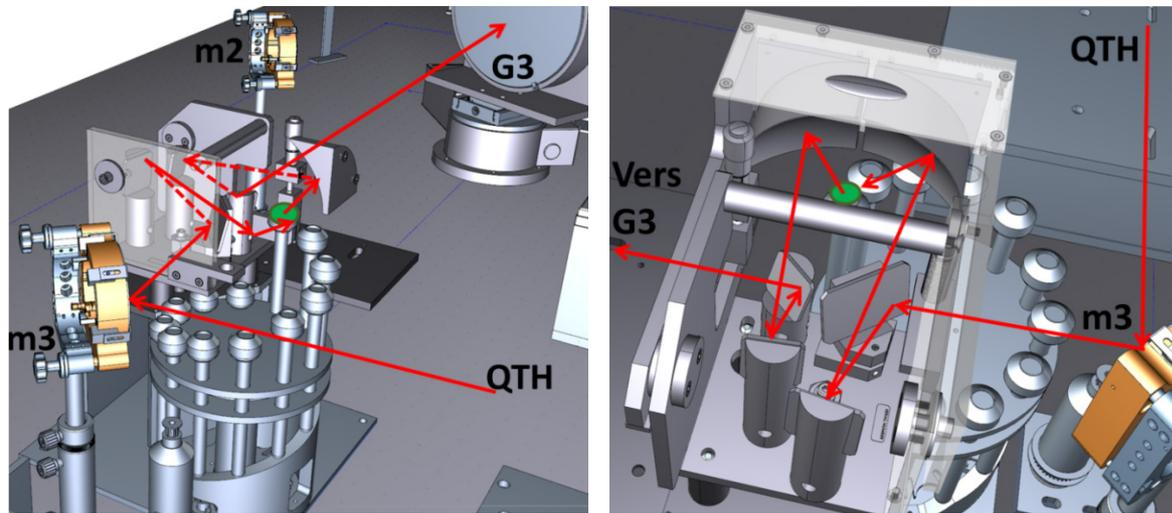
Figure 2-33. Système d'observation d'échantillons en réflectance.
