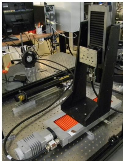
Figure 2-31. Système de platines de translation horizontale et verticale utilisées pour supporter les détecteurs de référence.
