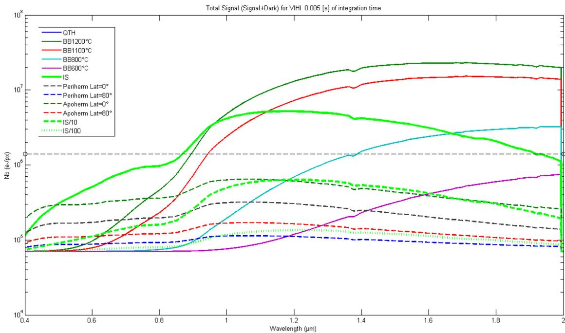
Figure 3-28. Signal total créé par un pixel du détecteur de VIHI pour un temps de pose de 5ms.
