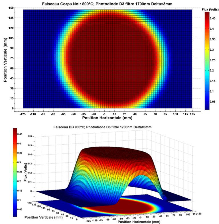
**Figure 4-11** Variation du flux pour  $T=800^{\circ}\text{C}$ , D3 avec la configuration actuelle du banc optique. La figure montre la représentation du faisceau 2D du corps noir à  $800^{\circ}\text{C}$  (figure du haut) et 3D (figure du bas). L'axe Z correspond au flux (Volts) mesuré avec le détecteur D3 muni d'un filtre passe bande centré à  $1700\text{nm}$  et  $\text{BW}=40\text{nm}$ .
