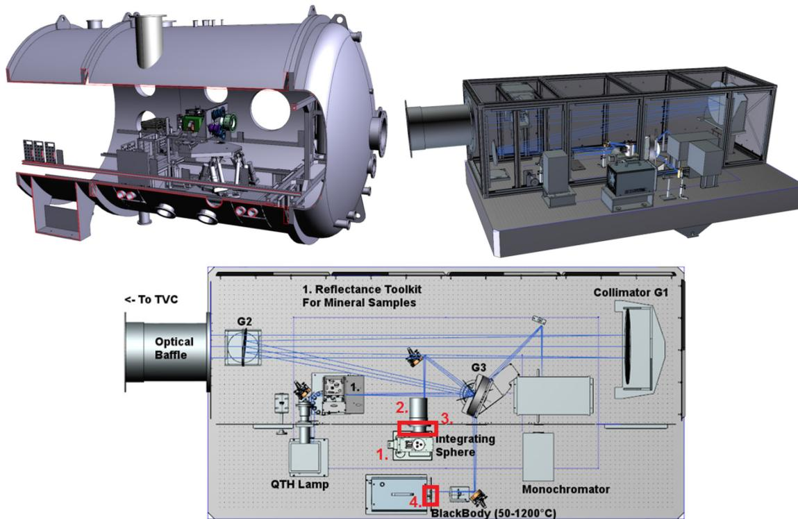
Figure 4-4 Modèle 3D de l'ensemble du système d'étalonnage de SIMBIO-SYS.
