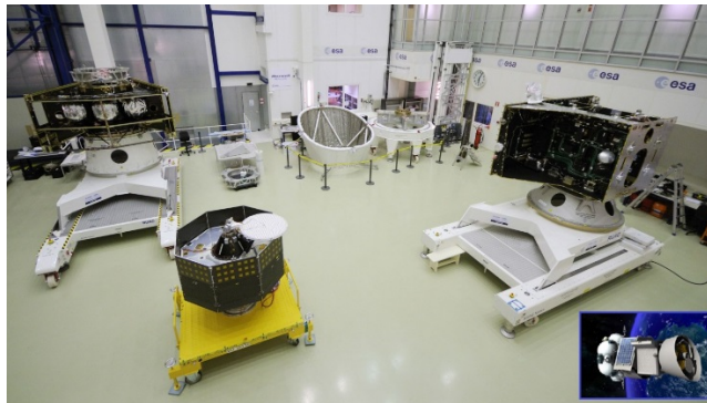
Figure 1-16 L'ensemble des modules qui forment la mission BepiColombo Au premier plan, le modèle structurel et thermique de l'orbiteur MPO (à droite) et le modèle structurel de l'orbiteur MMO. À l'arrière-plan à gauche, le modèle structurel et thermique du module de transfert et au fond à droite le bouclier solaire et la structure qui fera l'interface entre les deux orbiteurs lorsqu'ils seront intégrés en configuration de lancement. Dans le cadre bleu en bas à droite, un dessin représentant le vaisseau en vol de croisière.
