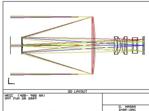
**Figure 1-20 Schéma optique de la voie HRIC**
