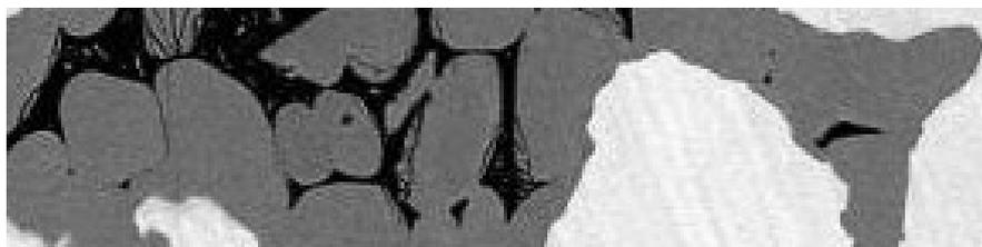
**Figure 1 - 7 : image en électrons rétrodiffusés d'un alliage aluminium-nickel indiquant la présence de trois zones de compositions distinctes. Plus la zone est foncée, plus elle est riche en élément léger, ici l'aluminium.**
