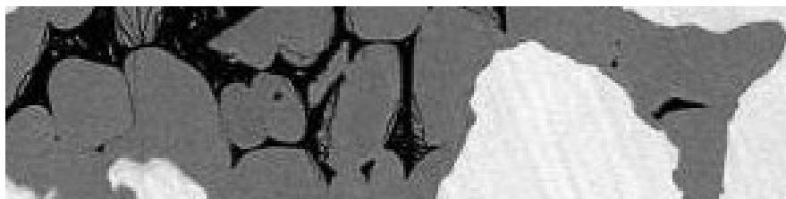
Figure 1 - 7 : image en électrons rétrodiffusés d'un alliage aluminium-nickel indiquant la présence de trois zones de compositions distinctes. Plus la zone est foncée, plus elle est riche en élément léger, ici l'aluminium.
