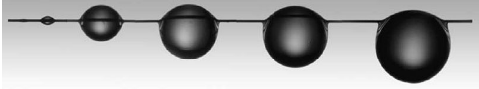
FIGURE 1.15 – Gouttes d’huile silicone de volumes \Omega = 0.01, 0.10, 0.23, 0.32 et 0.52 \mu\text{L} , accrochées à une fibre horizontale de rayon b = 12 \mu\text{m} . (Figure issue de [73].)
