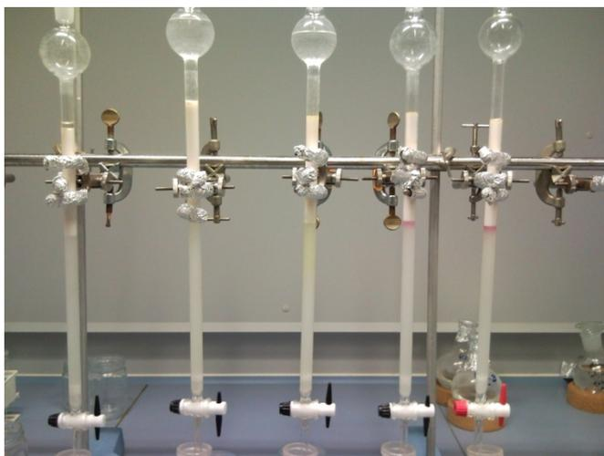
Figure 104 – Colonnes de purification silice/alumine pendant l'opération de cleanup des échantillons
