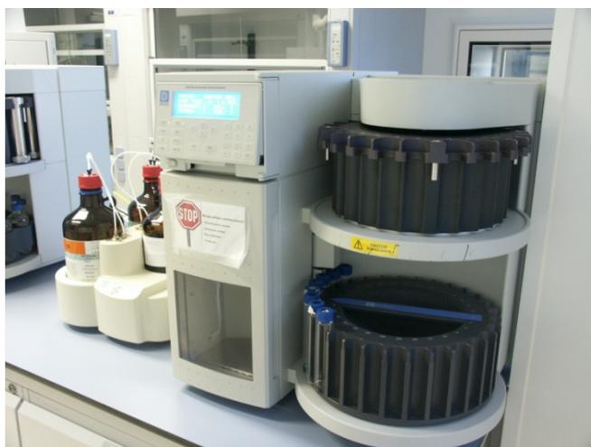
Figure 101 – Appareil d'extraction accélérée par solvant (ASE-Dionex 200)
