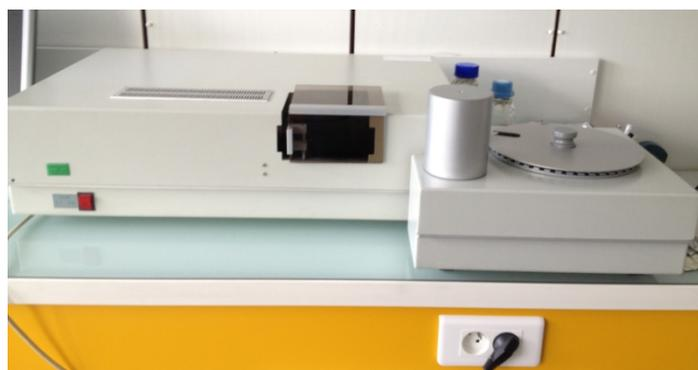
Figure 96 – Analyseur semi-automatique de mercure total AMA-254 (ALTEC)
