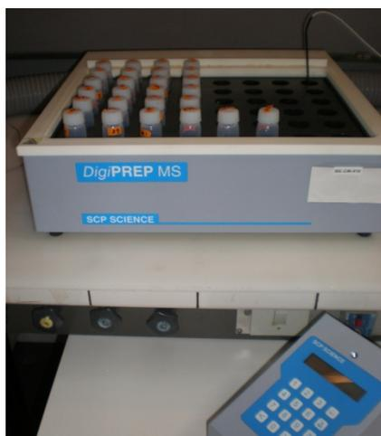
Figure 97 – Bloc chauffant Digi prep avec bombes en Teflon
