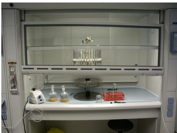
Figure 100 – Hotte aspirante sous laquelle l'ensemble des manipulations est effectué pour éviter toute contamination
