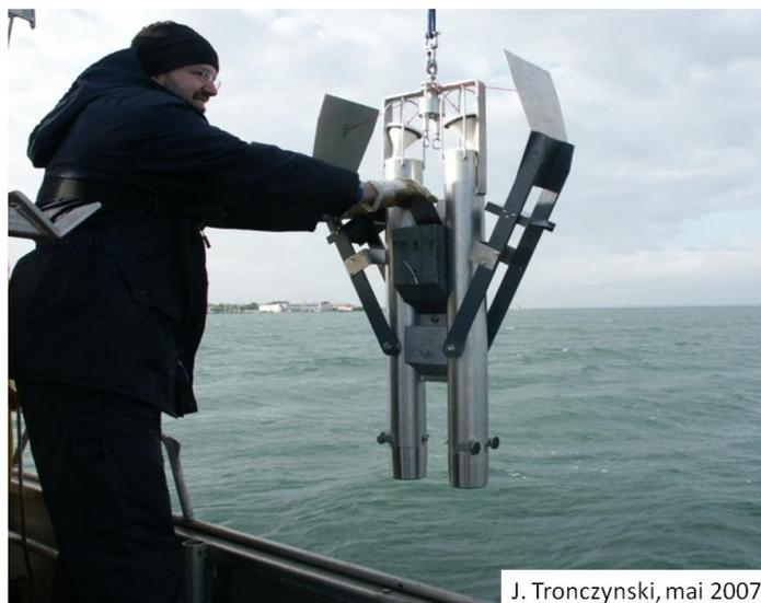
Figure 2 – Carottier Gemax utilisé pour le prélèvement des carottes C1 et C2 sur le plateau continental libanais
