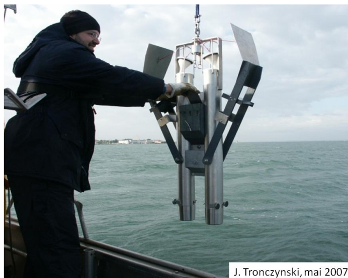
Figure 2 – Carottier Gemax utilisé pour le prélèvement des carottes C1 et C2 sur le plateau continental libanais
