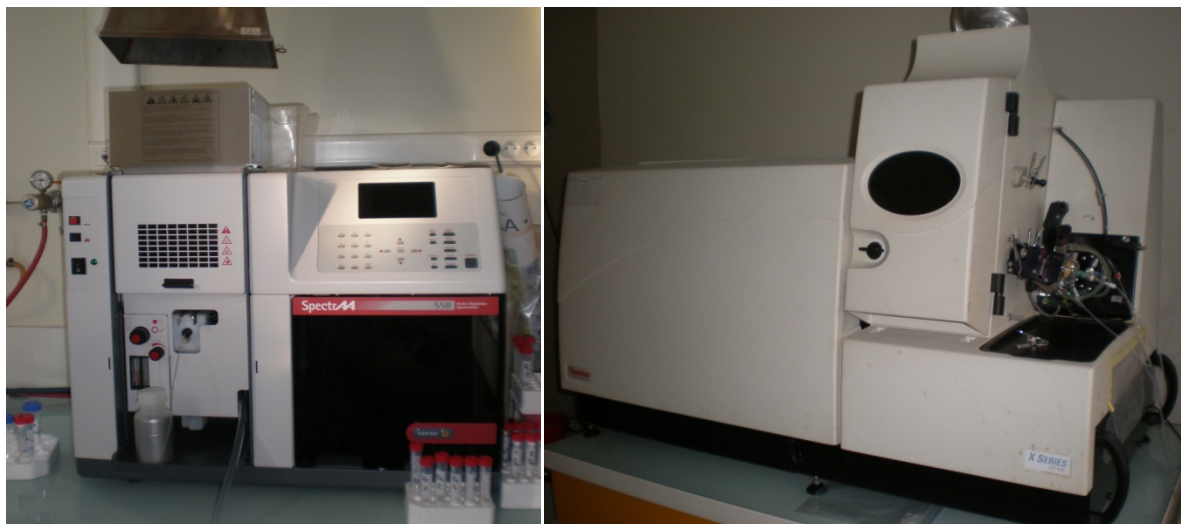
Figure 98 – Spectromètre d'absorption atomique de Flamme (SAAF) à gauche et spectromètre de masse couplé à un plasma inductif (ICP-MS) Thermo Element X Series
