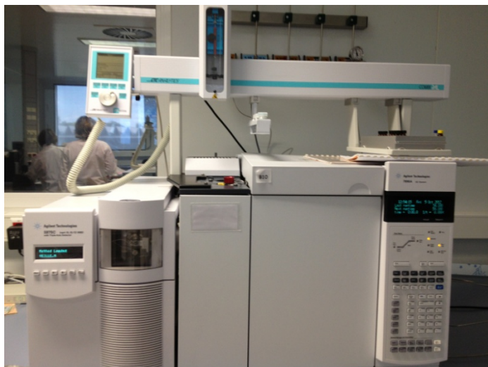
Figure 106 – Appareil de chromatographie en phase gazeuse Agilent 7890 couplé à un spectromètre de masse Agilent 5975C (CPG-MS)
