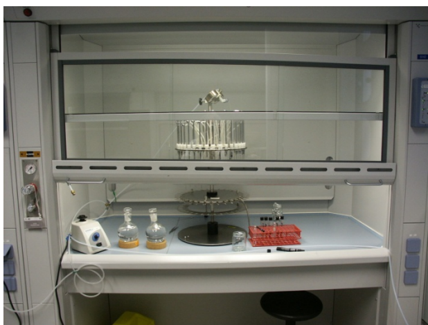
Figure 100 – Hotte aspirante sous laquelle l'ensemble des manipulations est effectué pour éviter toute contamination
