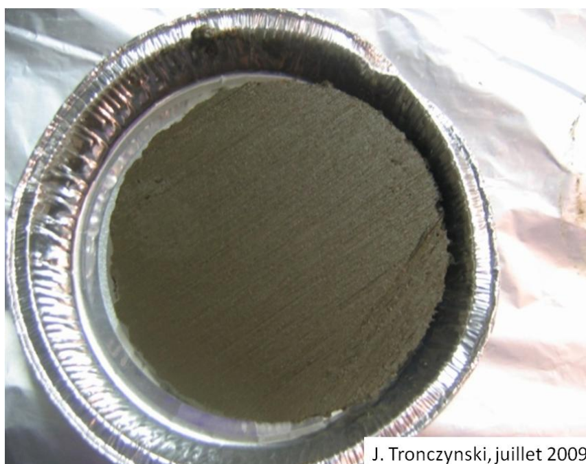
Figure 4 – Tranche de sédiments obtenue lors du découpage de la carotte sédimentaire C1
