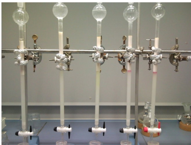
Figure 104 – Colonnes de purification silice/alumine pendant l'opération de cleanup des échantillons
