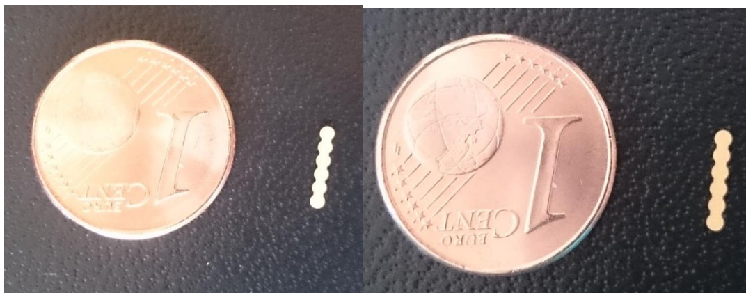
Figure III.54. Filtre large bande d'épaisseur 250 \mu\text{m} , avant et après métallisation.
