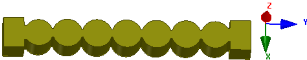
Figure III.18. Structure du filtre diélectrique sept pôles
