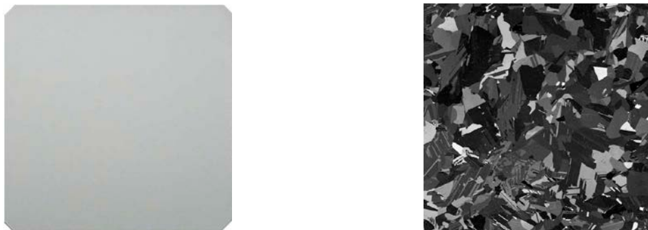
Figure 1. 17 : Plaquette de silicium à gauche monocristallin et à droite multicristallin
