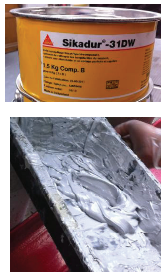
Figure III.34 : Colle époxydique Sikadur-31 DW.
