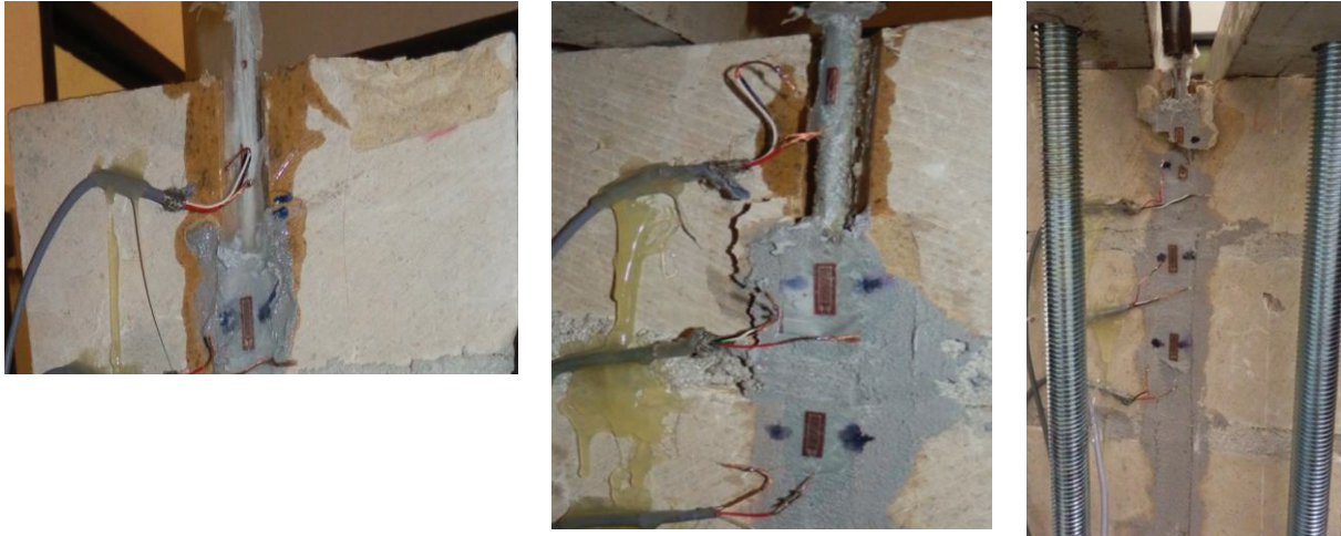
(a) Mode de rupture de l'éprouvette 1
