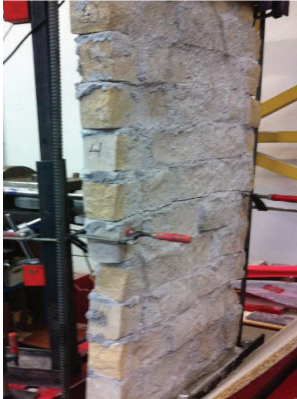
Figure V.4 : Mode de rupture du mur de maçonnerie non renforcé soumis à la flexion : fissuration du joint horizontal central.
