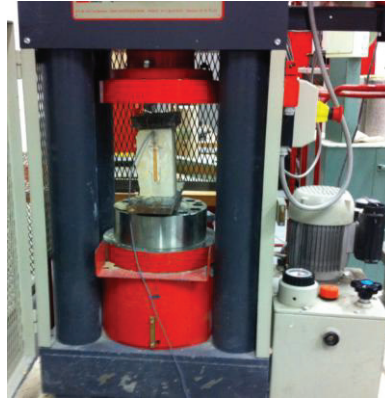
Figure III.1: Compression uni-axiale de la pierre : le dispositif expérimental.
