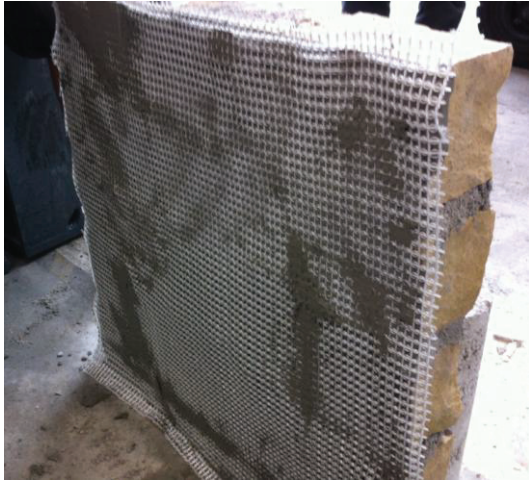
(a) Application du textile sur la première couche de mortier
