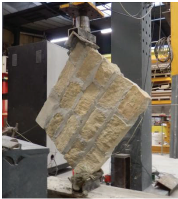
(a) instrumentation du mur chargé
