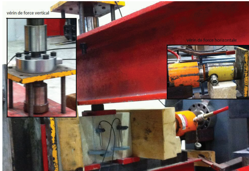
Figure III.17 : Essai de push-out : dispositif d'essai & vérins hydrauliques
