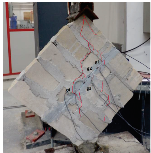
(b) : Deux fissures de la rupture
