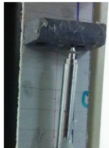
(c) Elargissement de fissures au milieu de l'éprouvette
