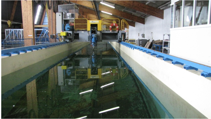
FIG. 2.3 – Canal de traction de Brest et son chariot de traction.
