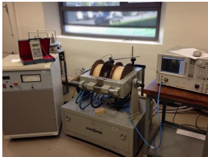
Figure IV-12. Photo du banc de caractérisation magnétique, laboratoire LT2C.
