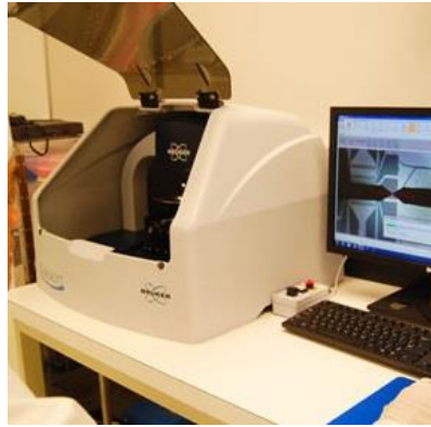
Figure IV-9. Instrument de mesure d'épaisseur (DEKTAK XT).
