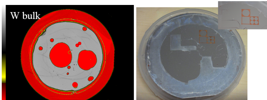
FIGURE B.2 – Problème de report de substrat Si sur embase métallique, avec de nombreux voids . Alors, seule une surface très faible a été exploitable pour fabriquer des diodes verticales de puissance.
