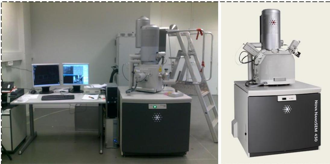
Figure II-19 Microscope électronique à balayage au sein de la Plateforme COP.
