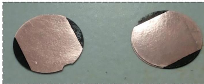
Figure IV-2 deux membranes avec un dépôt de Cuivre
