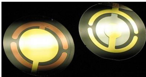
Fig A8 : Cristal de quartz recouvert d'électrode d'or : à gauche la surface de travail de 1 cm 2 .
