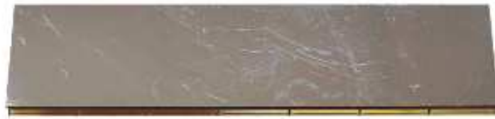
Figure 2.13 Photographie d'une barrette constituée d'un capteur de silicium pixellisé hybridé à 7 chips XPAD3 (Dawiec, 2011).
