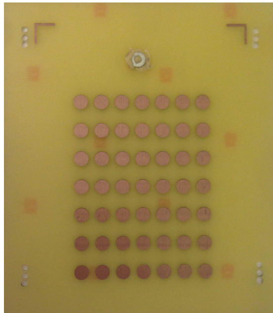
Figure 3.3 Photographie de la mire gravée sur une plaque de verre epoxy.
