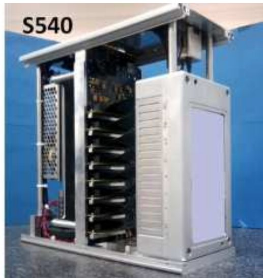
Figure 2.20 Photographie d'un détecteur XPAD (S540) vendu par la start-up imXPAD 22 .
