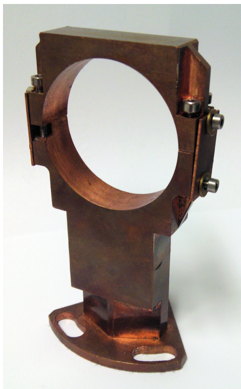
FIGURE 2.21: Photographie du porte échantillon fabriqué pour accueillir la cellule de pression. Deux plaques de cuivre OFHC sont utilisées pour faire le lien thermique entre les deux mors du porte-cellule.
