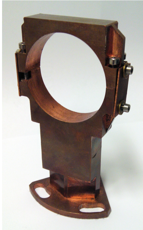
FIGURE 2.21 – Photographie du porte échantillon fabriqué pour accueillir la cellule de pression. Deux plaques de cuivre OFHC sont utilisées pour faire le lien thermique entre les deux mors du porte-cellule.
