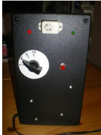
Figure 7.9 Dispositif électronique, réglé via une minuterie, permettant d'illustrer l'attente avant le départ de la course (diode rouge) puis d'indiquer le départ de la course (allumage d'une diode verte et émission d'un signal sonore).
