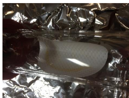
Filtre après exposition des particules de sulfate d'ammonium acidifiées à l' \alpha -pinène (1,0 ppm) pendant 90 min
