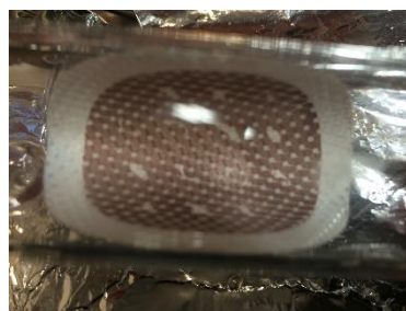
Filtres après exposition des particules de sulfate d'ammonium acidifiées à l' \alpha -pinène oxyde (3,3 ppm) pendant 140 min (à gauche) et 400 min (à droite)
