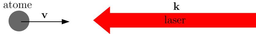
FIGURE 2.8 – Schéma de principe du ralentiement Zeeman : un atome de vitesse \mathbf{v} est soumis à un laser contra-propageant de vecteur d'onde \mathbf{k} .
