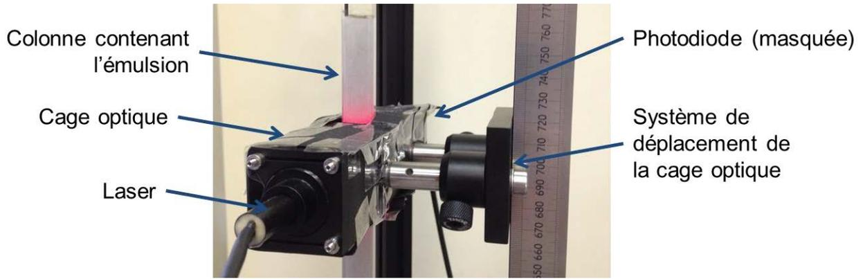
**Figure C.1** – Cliché du dispositif permettant de mesurer la DO de l'échantillon le long de la colonne d'émulsion.
