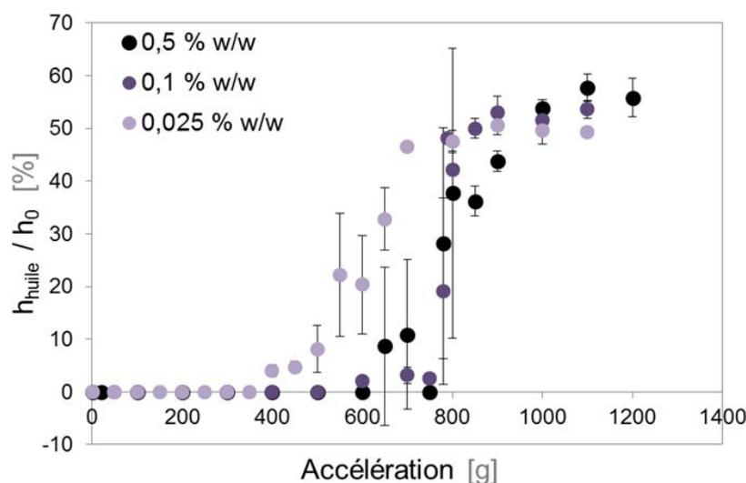
**Figure 4.25** — Evolution du taux de rupture en fonction de la vitesse de centrifugation. Chaque point correspond à la valeur moyenne calculée pour 3 échantillons. Emulsions préparées avec différentes concentrations en amodiméthicone dans l'IF : les symboles en noir correspondent au système général considéré auparavant (IF à 0,5 % w/w d'amodiméthicone dans l'ININ) ; les symboles en violet correspondent aux NB fabriquées avec des IF moins concentrées.
