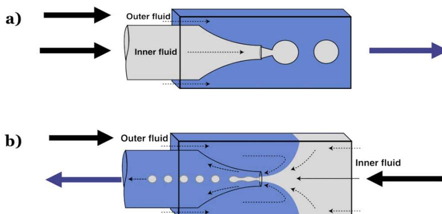
**Figure 1.16** – Schémas de dispositifs microfluidiques pour la production de gouttes. D'après Utada *et al.* [2007 (a)].
