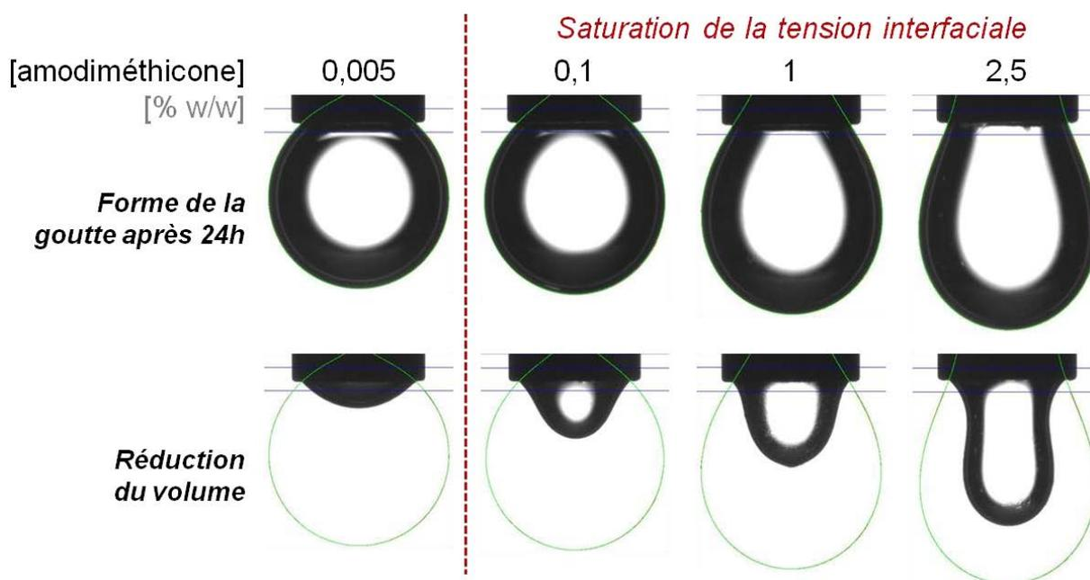
**Figure 2.24**—Clichés des gouttes stabilisées pendant environ 24 heures, avant et après aspiration de la phase aqueuse afin de réduire le volume de la goutte (constituée de carbomer à 0,005 % w/w dans l'eau), pour différentes compositions de la phase organique. Le diamètre externe de l'aiguille est 1,83 mm.
