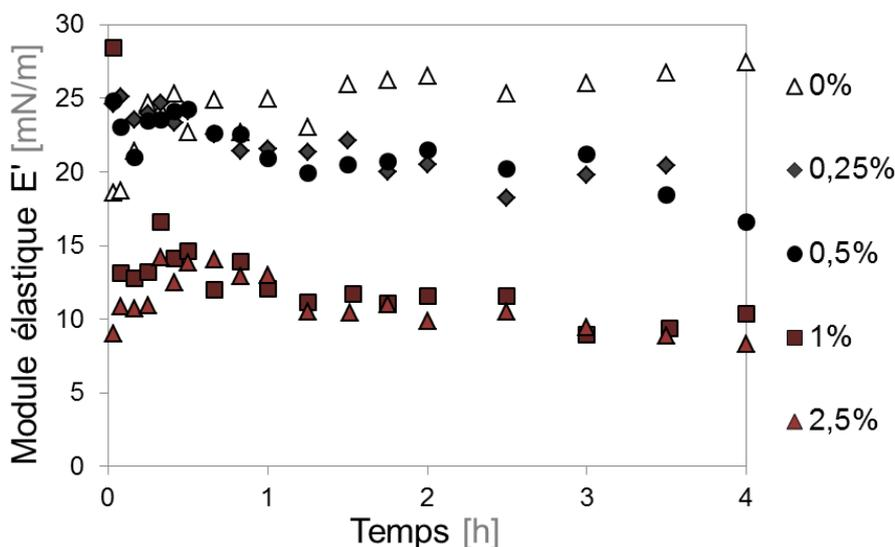
**Figure B.5** — Evolution cinétique du module élastique du système au cours du temps. La goutte est constituée d'une solution de carbomer à 0,005 % w/w dans l'eau. Chaque courbe correspond à une mesure pour une concentration donnée en amodiméthicone dans l'ININ. Le système sans amodiméthicone est représenté par les triangles blancs.
