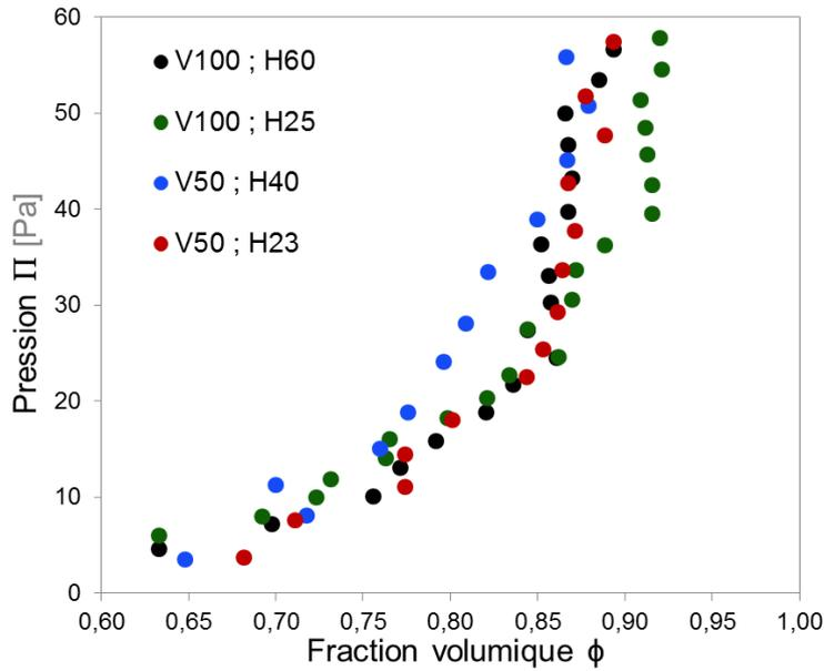
**Figure 4.6** — Evolution de la pression osmotique en fonction de la fraction volumique pour une émulsion millimétrique de NB (la phase continue est une solution de carbomer dans l'eau à 0,05 % w/w). Cas de différentes colonnes d'émulsion, résultats expérimentaux mesurés après 6 semaines de stabilisation.
