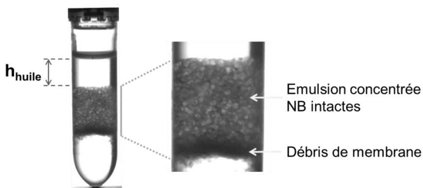
**Figure 4.11** —Cliché avec agrandissement de l'aspect d'un échantillon centrifugé présentant une rupture partielle de l'émulsion. L'interface entre la couche d'huile libérée et les gouttes d'émulsion intactes est nette. Les débris de membranes ont migré au bas de la colonne d'émulsion (couche plus sombre sur le cliché).
