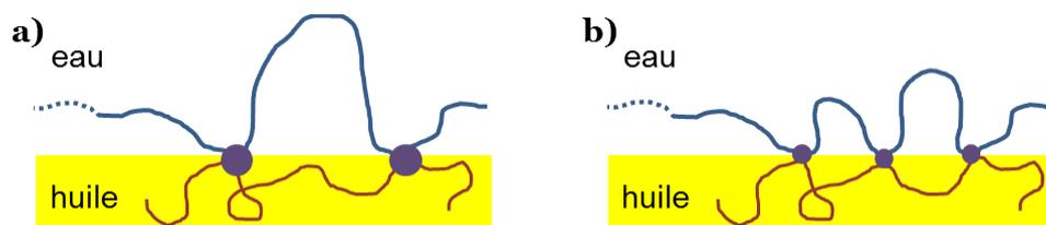
**Figure 4.20**—Effet de la présence d'ions dans la phase continue. Le carbomer est représenté en bleu et l'amodiméthicone en rouge ; les points de réticulation électrostatique qu'ils forment sont symbolisés en violet. Les groupements et les charges ne sont pas représentés.
