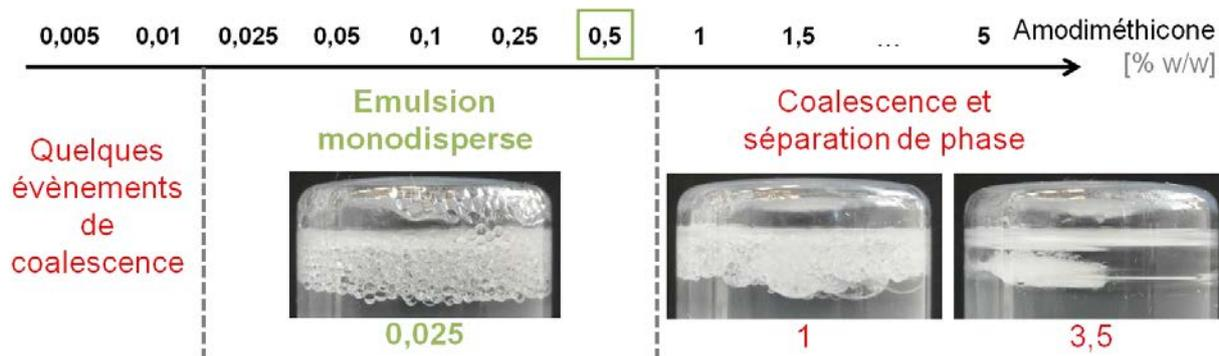
**Figure 3.10** — Synthèse des résultats expérimentaux pour l'étude de l'influence de la quantité d'amodiméthicone dans l'ININ pour l'IF. La concentration généralement utilisée dans le procédé de fabrication des NB est entourée en vert (0,5 % w/w). Les clichés présentent quelques exemples de l'aspect des échantillons.
