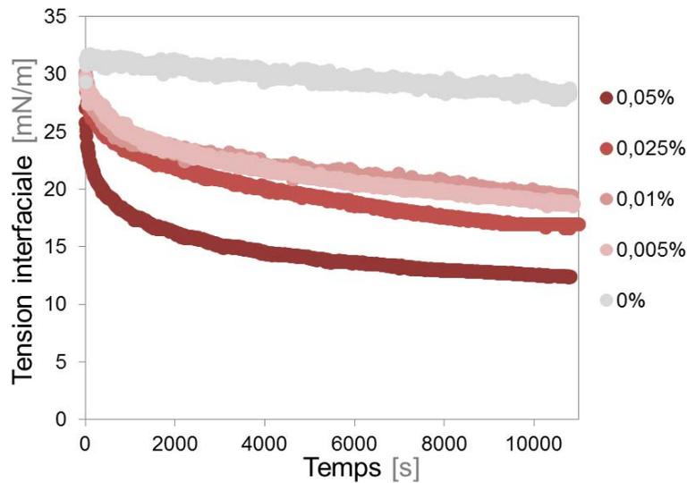
**Figure A.1** – Evolution cinétique de la tension interfaciale pour différentes compositions de la phase organique. La phase qui constitue la goutte est une solution de NaCl à 0,01 g.mL<sup>-1</sup> (environ 0,17 mol.L<sup>-1</sup>) dans l'eau.
