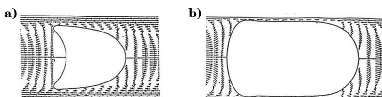
**Figure 5.2** – Représentation de la forme à l'équilibre pour des capsules sous écoulement axisymétrique à travers une constriction, dans des conditions de flux identiques (le nombre capillaire vaut 0,04). D'après Quéguiner *et al.* [1997].
