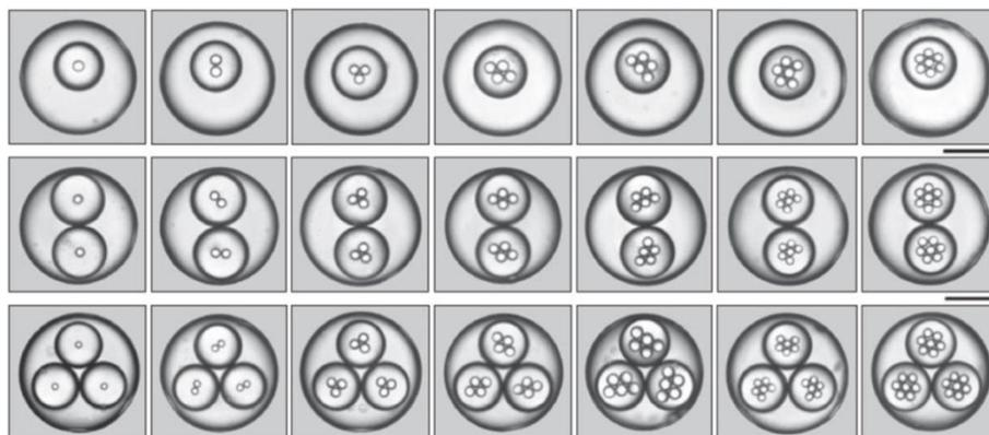
**Figure 1.18** – Exemples de gouttes d'émulsions triples monodisperses fabriquées avec des microcapillaires. Les barres d'échelle sont de 200  $\mu\text{m}$  et s'appliquent à toutes les images. D'après Utada *et al.* [2007 (a)].
