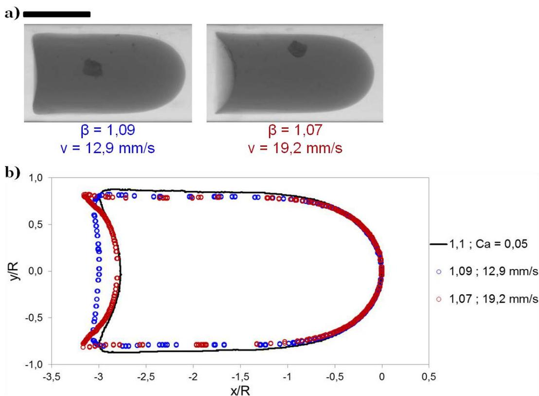
**Figure 5.15** — a) Clichés des NB circulant dans le capillaire. La phase externe est du glycérol à 85 % w/w dans l'eau, soit  $\eta_o/\eta_w = 0,06$ . Flux de gauche à droite. Barre d'échelle = 1 mm ;
