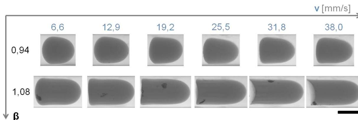
**Figure 5.13** — Diagramme de forme des NB pour deux taux de confinement différents et différentes vitesses du fluide porteur (glycérol à 80 % w/w dans l'eau).  $\eta_o/\eta_w = 0,11$ . Flux de gauche à droite. Barre d'échelle = 1 mm.
