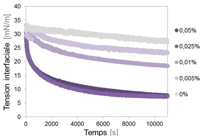
**Figure A.3** — Evolution cinétique de la tension interfaciale pour différentes compositions de la phase organique : différentes concentrations d'amodiméthicone dans l'ININ. La phase qui constitue la goutte est une solution de carbomer à 0,005 % w/w dans l'eau.
