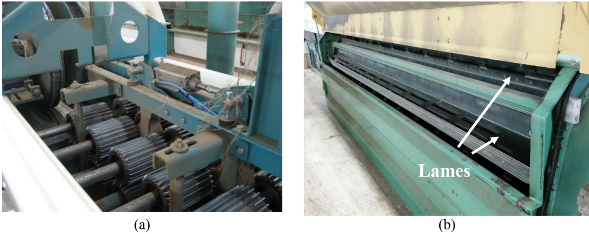
Figure 24 Système de broyage à rouleaux cannelés (a) et système de battage (b).
