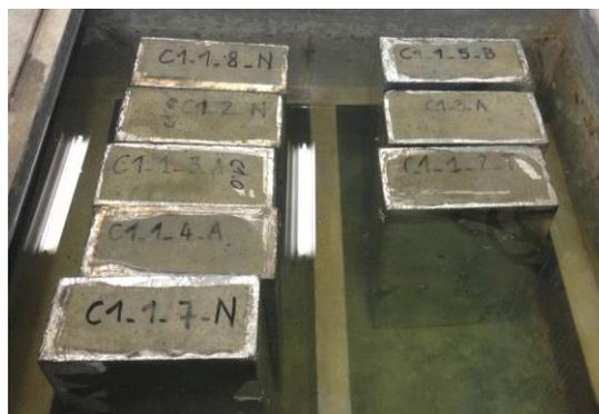
Fig. 3.2. Dalles du béton C1 en condition saturée
