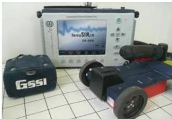
*Fig. 2.4. Système d'acquisition radar*
