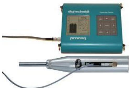
*Fig. 2.9. Scléromètre SCHMIDT 2000*
