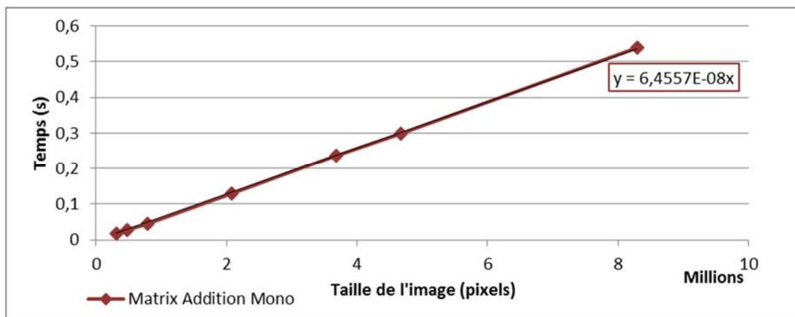
Figure 60 Résultats d'additions de deux images sur Raspberry Pi
