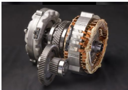
(a) - Photo de la chaîne de traction Toyota (2010)
