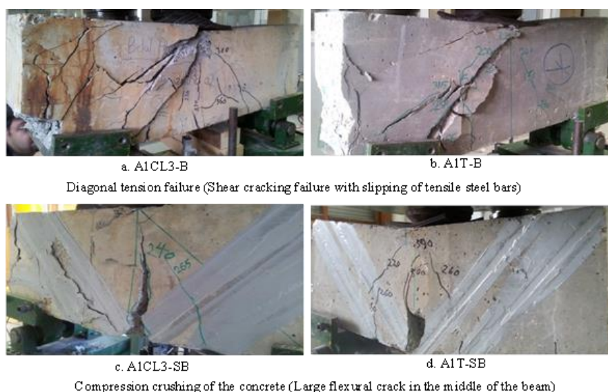
Figure I- 7 modes de ruine des quatre poutres courtes
