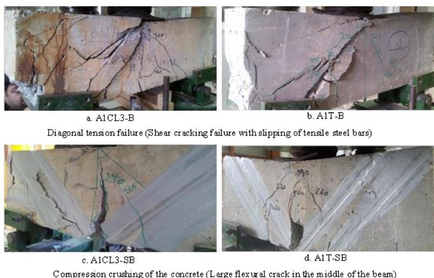
Figure I- 7 modes de ruine des quatre poutres courtes
