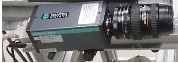
**Figure 81** - Camera Hisense MkII double trame de Dantec utilisée pour PIV.
