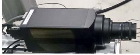
**Figure 78** - Camera PIMAX 2 de Princeton Instruments utilisée pour l'acquisition PLIF à 308 nm. Un modèle identique est également utilisé pour la fluorescence à 266 nm.
