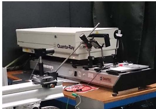
**Figure 72** - LASER Nd-YAG utilisé pour générer l'excitation à 266 nm.
