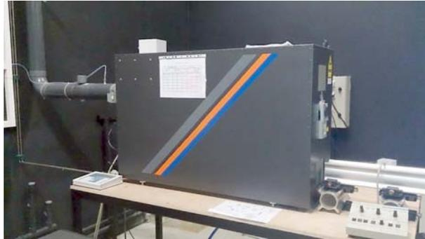
**Figure 64** - LASER Excimer utilisé pour obtenir l'excitation à 308 nm (COMPEX Pro de marque Coherent).
