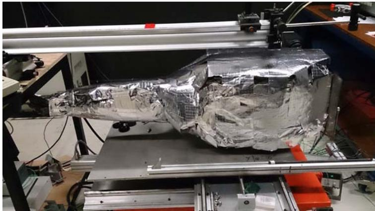
**Figure 41** - Veine installée sur son système de déplacement et isolée par de la laine de roche de 80 mm d'épaisseur.
