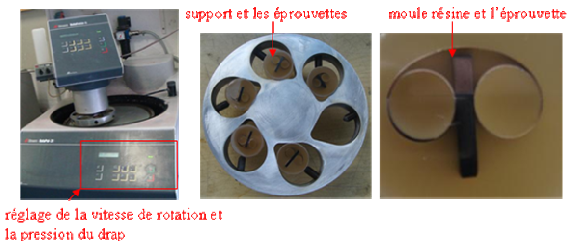
Figure 40 : Montage pour le polissage automatique.
