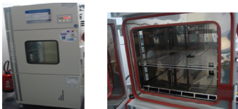
Figure 43 : Enceinte contrôlée en température et en humidité pour les essais de diffusion d'eau à haute température.
