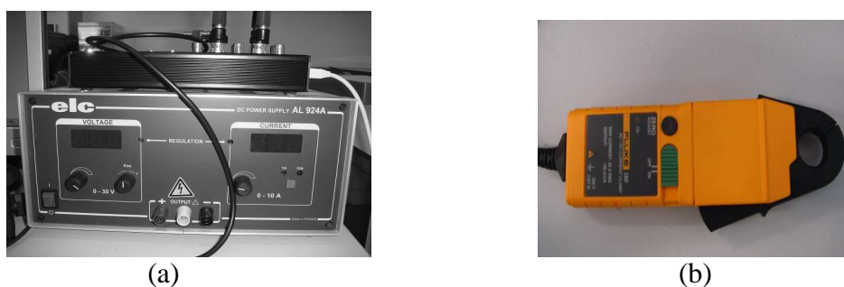
Figure 29 : (a) Alimentation électrique hautement stabilisée ; (b) boîtier d'acquisition analogique pour la mesure de la tension électrique.
