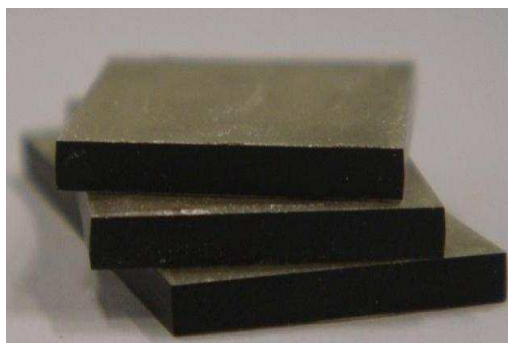
Figure 37 : Photos d'éprouvettes avec un dépôt de laque d'argent sur les surfaces supérieures et inférieures.
