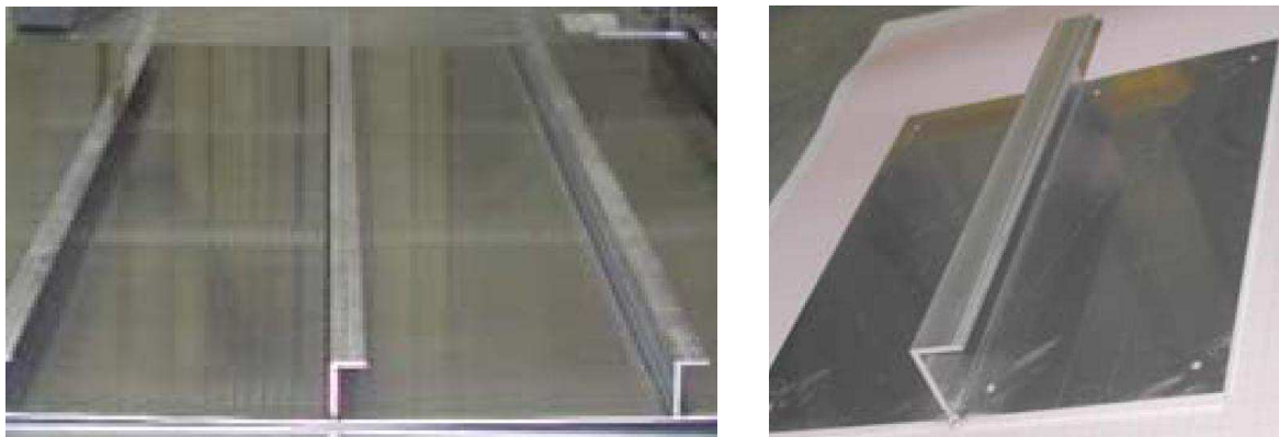
Figure 122 : Pièce de structure de fuselage (en matériau métallique) et éprouvette représentative.
