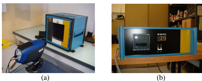
Figure 30 : La caméra infrarouge, le montage et le « corps noir » utilisés pour la calibration et l'étalonnage de la caméra.
