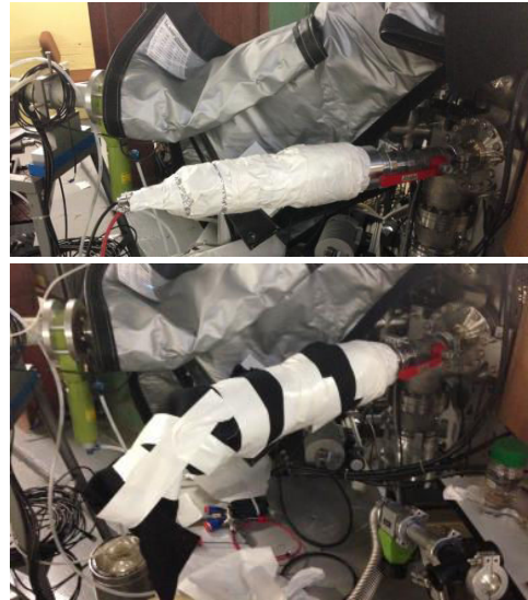
Figure 3.5 - Dispositif du PMT H1949-51 isolé de la lumière pour l'irradiation par des sources gamma et protons.
