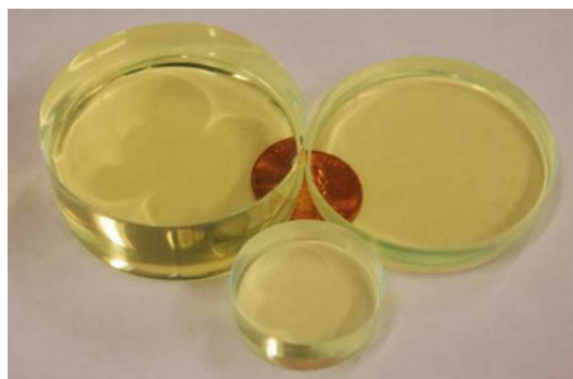
Figure 1.17 – Photographie du scintillateur plastique composé d'un complexe d'iridium synthétisé des travaux de Feng.
