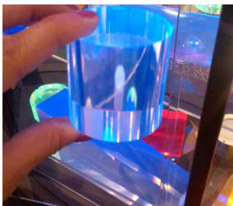
Figure 1.21 – Photographie du scintillateur synthétisé sur la base des travaux de Zaitseva commercialisé sous le nom EJ-299-33 sous lampe UV.
