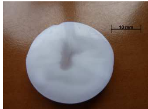
Figure 4.15 - Photographie du scintillateur plastique TO-iP15-pT-P qui a entièrement blanchi 1 mois après sa préparation. Il est de diamètre 30 mm.
