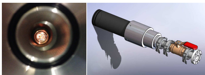
Figure 3.3 – Les protons sont rétrodiffusés sur une cible d'or (gauche) et sont centrés dans le dispositif (droite). Les protons irradient un scintillateur plastique donné situé dans la partie métallique (droite). La scintillation en sortie est collectée dans un PMT situé dans l'enceinte noire (droite). Les protons peuvent être arrêtés à l'aide de la vanne rouge (droite).
