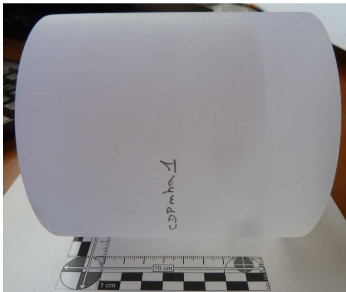
Figure 2.1 – Photographie d'un scintillateur plastique du laboratoire \varnothing 109 mm \times hauteur (h) 114 mm ( \approx 1 L).
