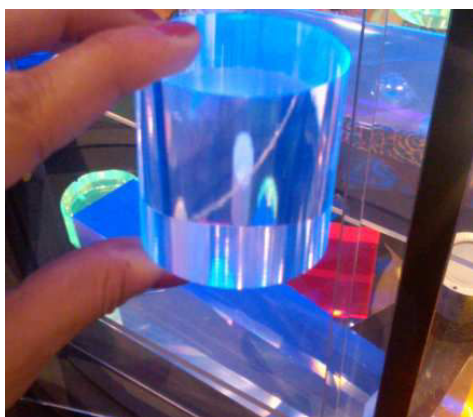
Figure 1.21 – Photographie du scintillateur synthétisé sur la base des travaux de Zaitseva commercialisé sous le nom EJ-299-33 sous lampe UV.
