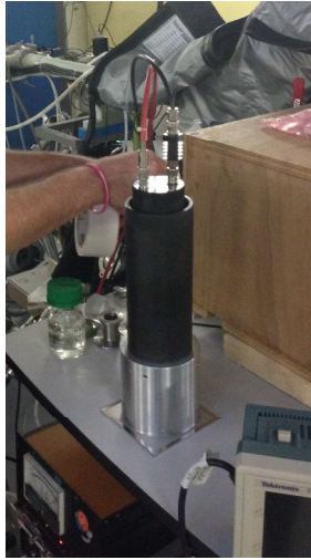
Figure 3.4 - Dispositif ensuite isolé de la lumière où le PMT H1949-51 est posé sur la plaque d' ^{241}\text{Am} .
