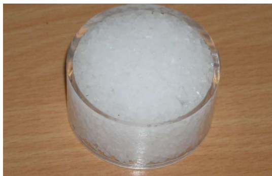
Figure 1.20 – Photographie d'un scintillateur plastique Polysiloxane contenant des grains de monocristaux de p -terphenyle de l' Institute for Scintillation Materials of National Academy of Sciences of Ukraine .
