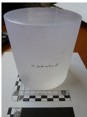
Figure 1.19 – Photographie d'un scintillateur plastique synthétisé dans notre laboratoire.
