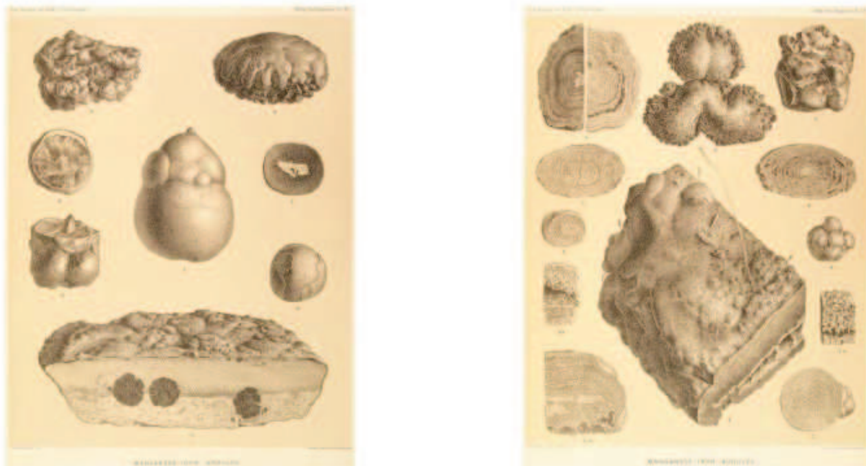
Figure I.1 : Dessins d'observation de nodules polymétalliques et d'encroûtements de fer-manganèse collectés lors de l'expédition océanographique du navire H.M.S Challenger de Décembre 1872 à Mai 1876 extraits du rapport scientifique de l'expédition (Murray and Renard, 1891).
