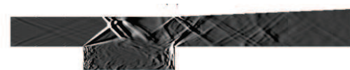
FIGURE 6.2: Champ Schlieren obtenu par simulation TANN-LES [84].
