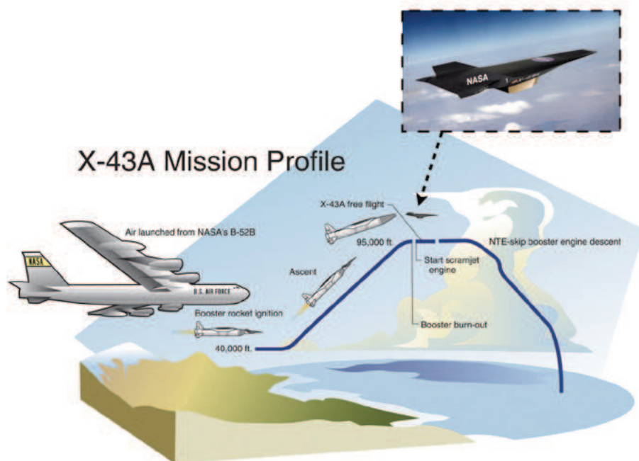
FIGURE 1.8: Schéma représentant l'ascension du scramjet X43-A en 2004 depuis son lancement depuis le bombardier B-52B [3].
