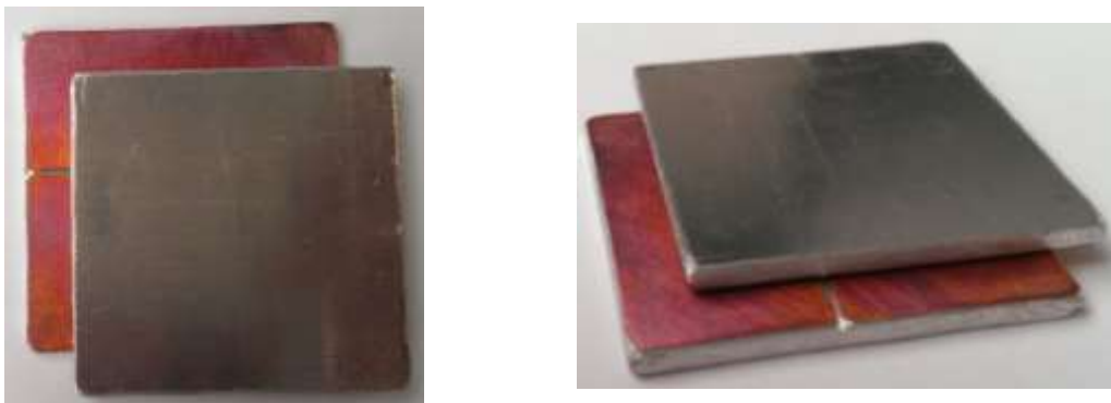
Figure 4.12 : Photographie de l'assemblage double face pont de diodes sous plusieurs angles
