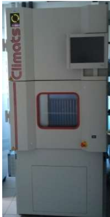
Figure 2.18 Enceinte climatique Climats série CTr équipée de deux chambres permettant de réaliser des essais de vieillissement passif de type choc
