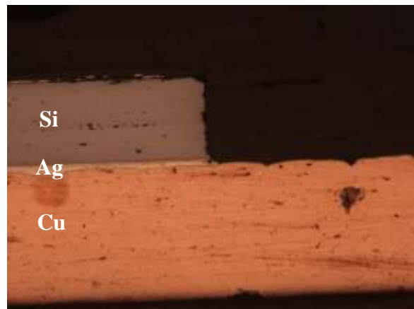
Assemblage F (puce petite) 800 cycles Fissure dans la céramique sous toute la puce
