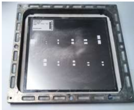
Figure 2.3 : Clinquant de 100 \mu\text{m} permettant de sérigraphier la pâte d'argent sur les substrats pour différentes tailles de puces semi-conductrices
