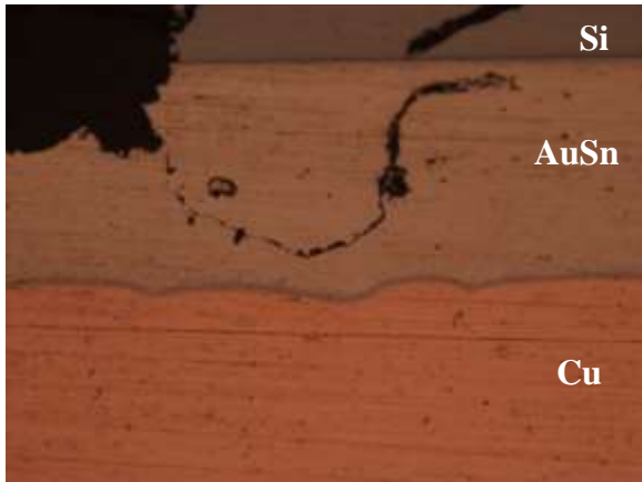
Assemblée A (puce petite) 800 cycles Fissure dans brasure
