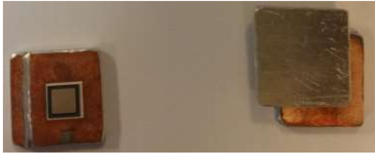
Figure 4.13 Assemblages spécifiques réalisés pour la mesure de la résistance thermique : assemblage simple face non câblé (gauche) et assemblage double face (droite)
