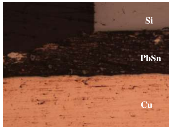
Assemblages B (puce petite) Présence d'intermétallique
