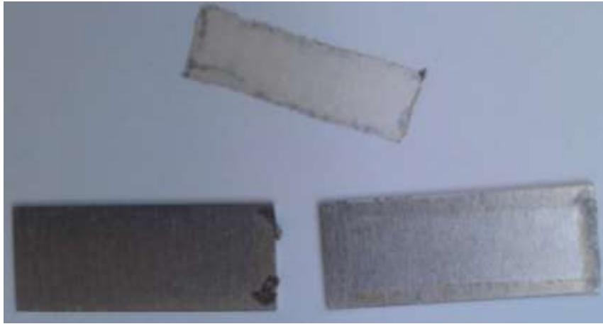
Figure 4.1 : Pâte d'argent Argomax® 2020 frittée entre deux plaques en nickel - les trois parties se séparent naturellement du fait de la fonction barrière que joue le nickel sur la diffusion de l'argent
