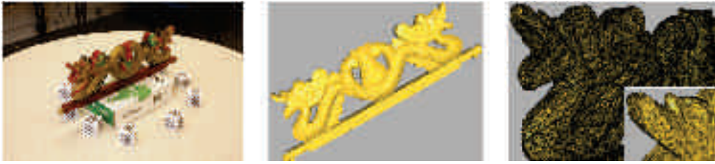
Figure 1.2 : Numérisation d'un objet réel (gauche), résultant en une reconstruction fine de sa forme (centre) grâce à la représentation par maillage surfacique dense, composé de millions de sommets plongés dans l'espace (droite).
