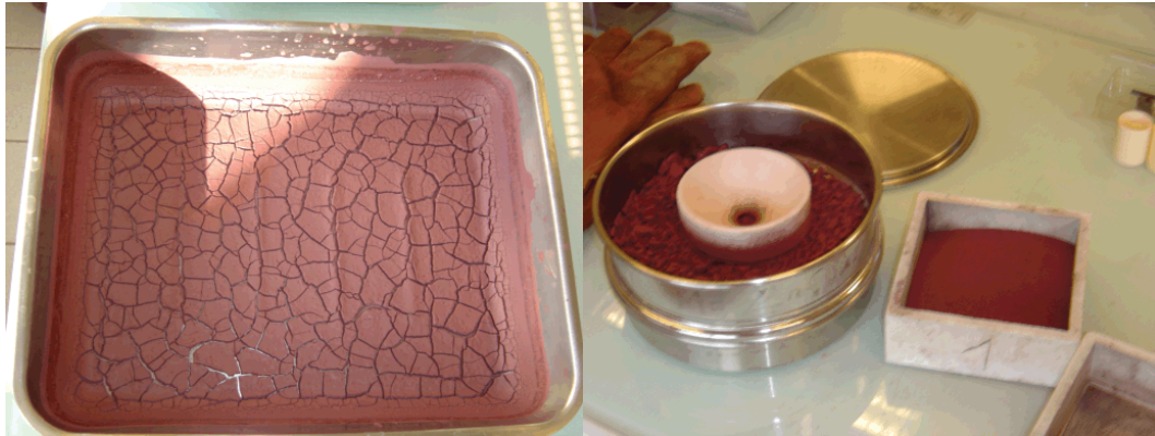
FIG. 4.50 – Séchage et passage au tamis de la poudre broyée.
