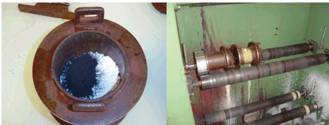
FIG. 4.49 – Mélange des poudres d'oxydes et jarre avant et pendant le broyage.
