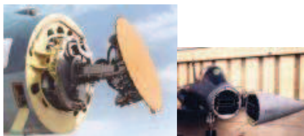
FIG. 1.13 – Exemples de radars avant
