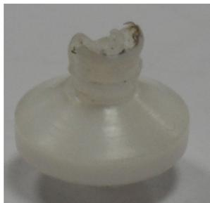
Figure 39 : Joint de la vanne HPLIS usagé
