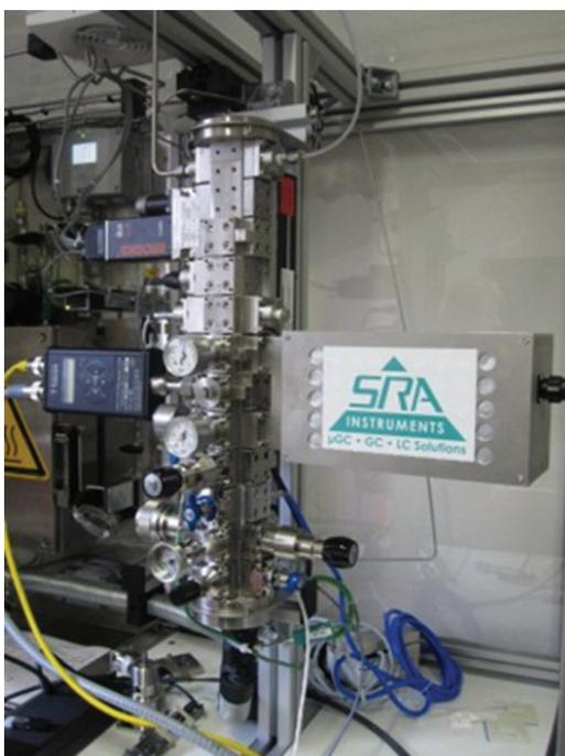
Figure 4 : Micro-chromatographe SRA Instrument monté sur platine Astute
