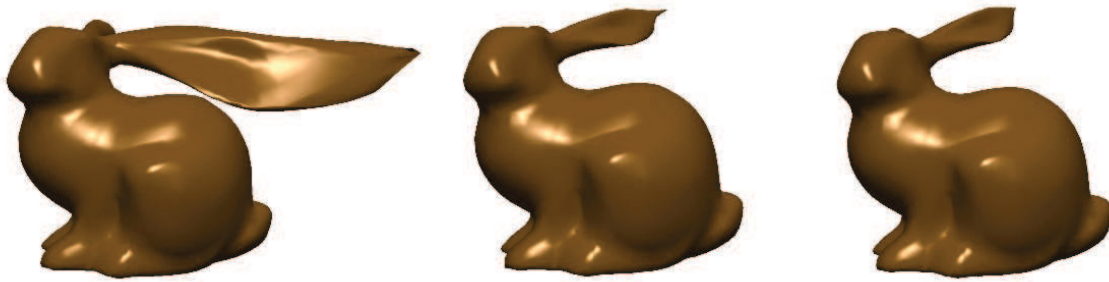
FIGURE 3.5: Les résultats de Georgii et al. [4] montrent trois types de formulations des contraintes d'un même objet tétraédrique subissant une même déformation (de gauche à droite, linéaire, co-rotationnelle et non-linéaire). Nous remarquons que la formulation co-rotationnelle permet d'obtenir une bonne estimation du résultat obtenu avec une formulation non-linéaire.
