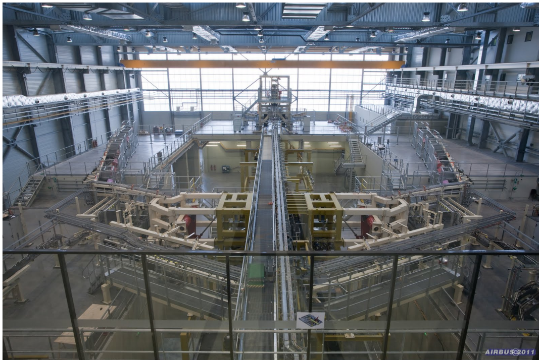
FIGURE 1.16 – Exemple de plateforme de simulation complexe : HIL, IronBird de l'Airbus A350
