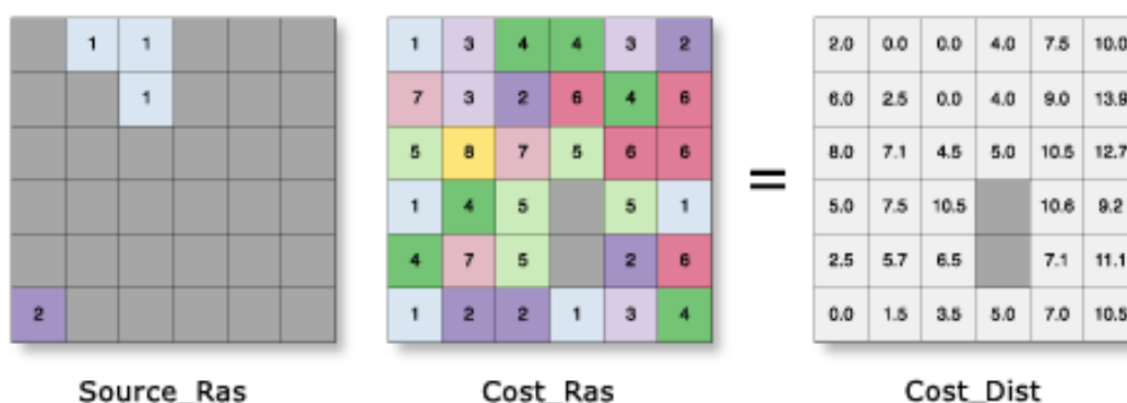
Figure 73 : Principe d'un géotraitement Cost Distance (source : ESRI)
