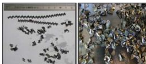
Figure 1-2 Copeaux obtenus lors du perçage traditionnel (à gauche) et du perçage vibratoire (à droite).
