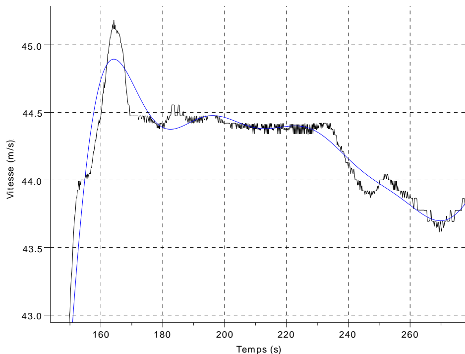
FIGURE 3.19 – Vitesse brute (en noire) et vitesse filtrée (en bleue) en fonction du temps, essai M26017.
