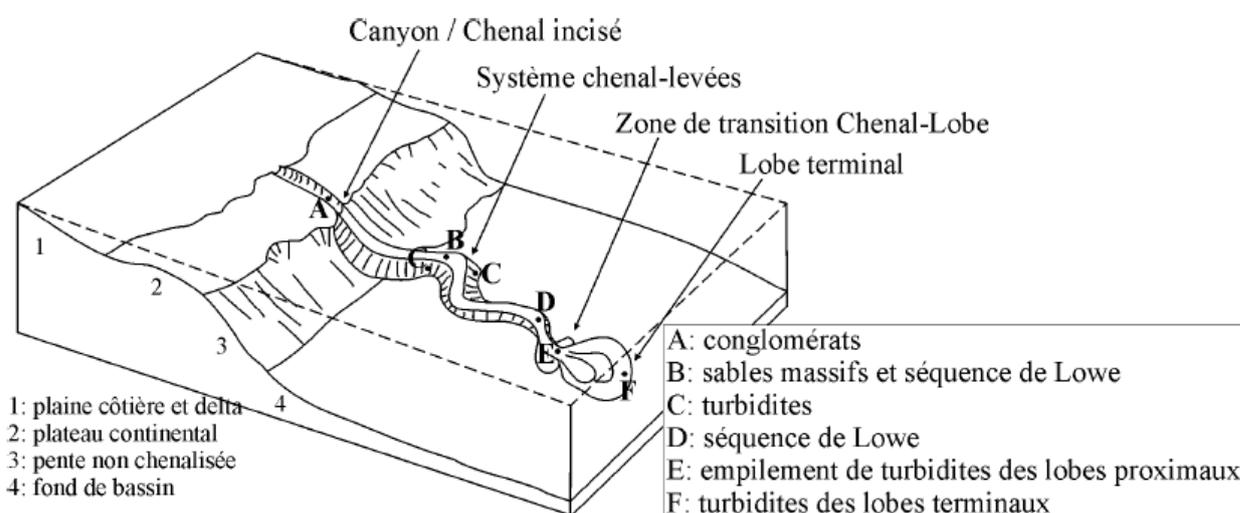
Figure I-18: Schéma d'un système turbiditique de type chenalisé et les types de dépôts rencontrés ([Galloway, 1998](#); [Reading and Richards, 1994](#)) modifié par Mas (2009).
