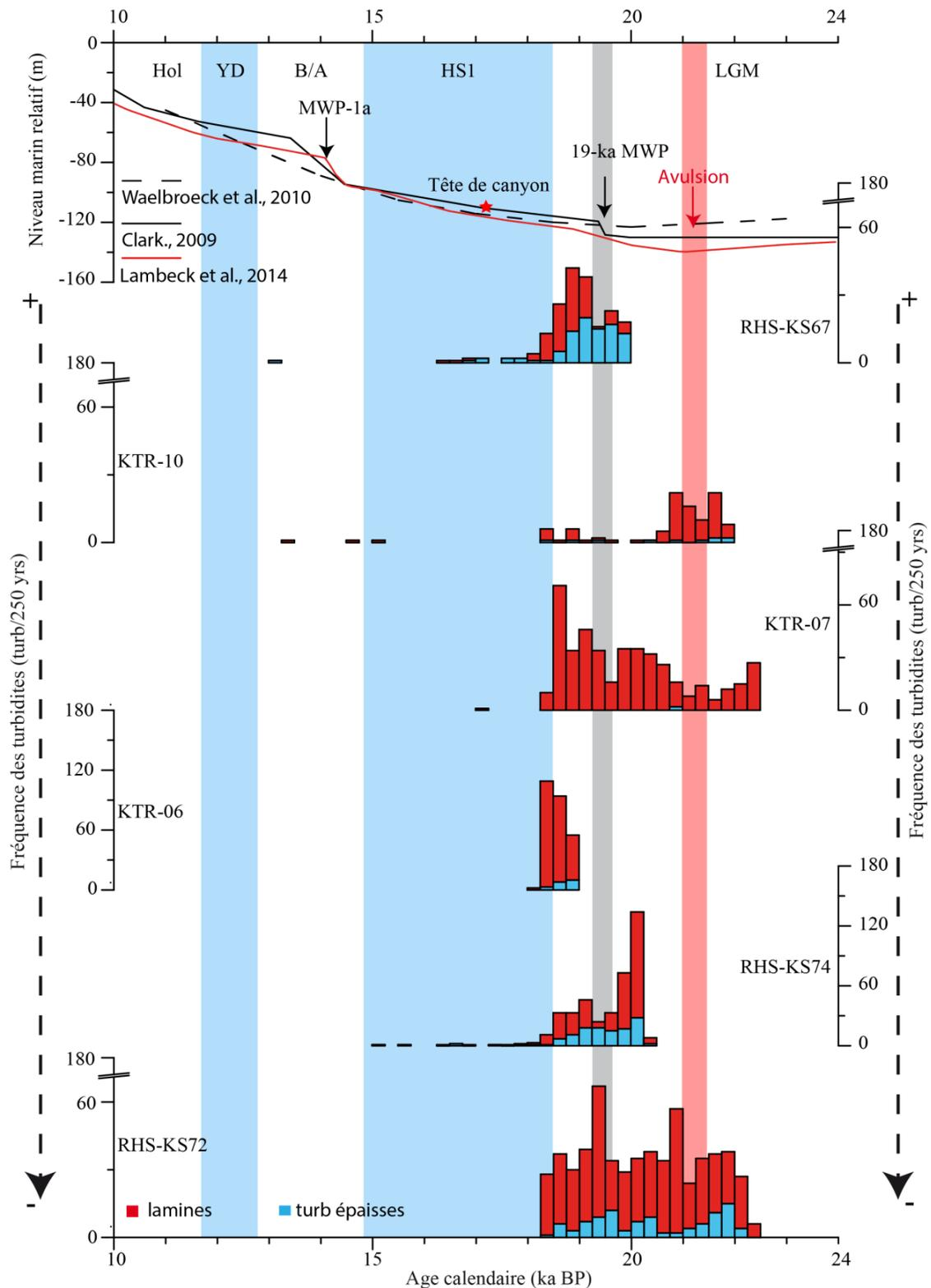
Figure VI-3: Comparaison de l'activité turbiditique exprimée en fréquence de turbidites des carottes du chenal et Néochenal du Petit-Rhône par rapport aux variations du niveau marin relatif entre 24 et 10 ka cal. BP. Le sens des flèches indique l'arrangement des carottes des plus proximales vers les plus distales.
