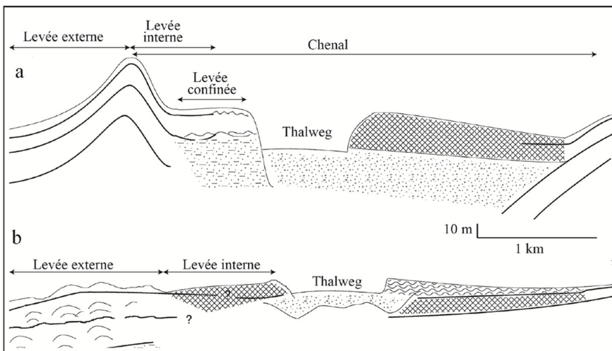
Figure I-20: Vu schématique de l'évolution morphologique d'un complexe chenal-levée d'amont (a) en aval (b) adapté d'après Piper et al (1999).
