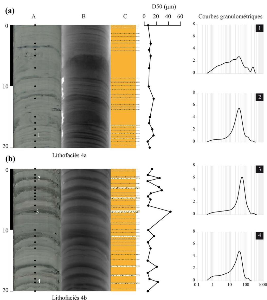
Figure V-30: Illustration des turbidites argilo-silteuses, A: photographie, B: image rX, C: interprétation lithologique. Les turbidites argilo-silteuses correspondent aux lithofaciès (a) 4a et (b) 4b.
