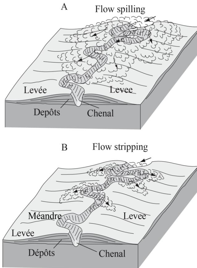
Figure I-23: Vu 3D des débordements de types A) spilling ([Hiscott et al., 1997](#)), B) stripping ([Piper and Normark, 1983](#)). La direction de l'écoulement est donnée par les flèches (Babonneau 2002 in Mulder 2011).
