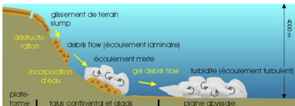
Figure I-11: transformation d'un glissement de terrain en écoulement laminaire puis turbulent le long d'une marge continentale (Ravenne and Beghin, 1983) ([www.ulg.ac.be](http://www.ulg.ac.be)).
