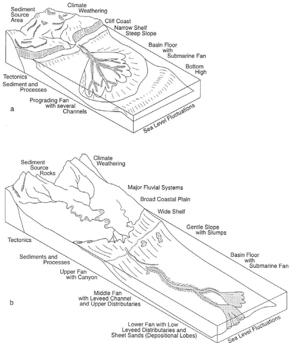
Figure I-17: Représentation schématique des deux types de systèmes turbiditiques chenalés: a) système à grain grossier et b) système à grain fin (Bouma, 2004).
